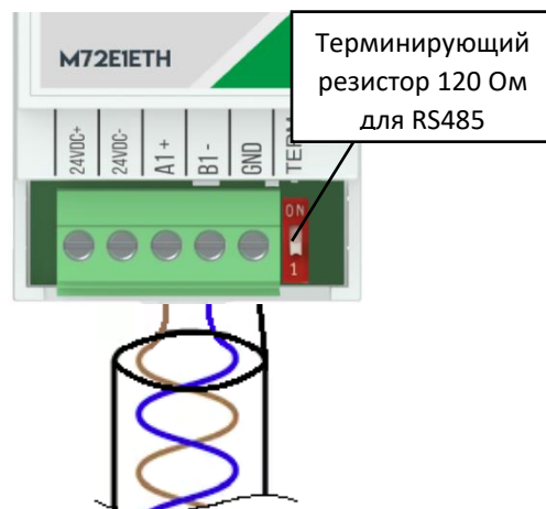
Сеть RS485 (Modbus RTU)
