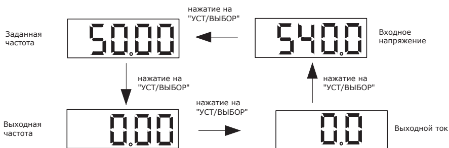
Рисунок 5.5-2. Переключение контролируемых параметров
