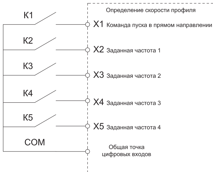
Рисунок 10.18-1. Схема подключения клемм
