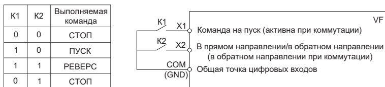
Рисунок 10.9-6. Двухпроводная схема управления 2
